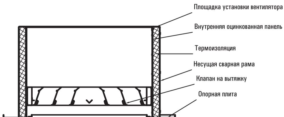
Стаканы серии МонСт-Ш (шумоглушащий) отличаются от МонСт наличием на внутренних боковых стенках звукопоглощающего материала. На стаканах МонСт-Ш 1065 и выше имеются дополнительные кассеты со звукопоглощающим материалом. Ниже в таблице приведены величины ослабления шума в стакане типа МонСт-Ш:
